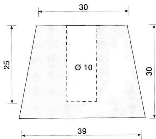
I blocchi di fondazione sono costruiti in calcestruzzo AR ed inerti lavati di cava, vibrati. Di tipo unico, servono per l'ancoraggio di paletti di ferro per la successiva posa di reti metalliche per recinzioni.
