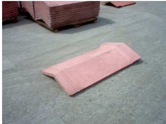
I nostri copponi sono prodotti con appositi mescolatori, con metodo vibrogettato, con un impasto formato da cemento AR, inerti di cava lavati aventi granulometria adeguata, fibre strutturali sintetiche, miscelati con fluidificante e ossido di colore rosso o nero .
