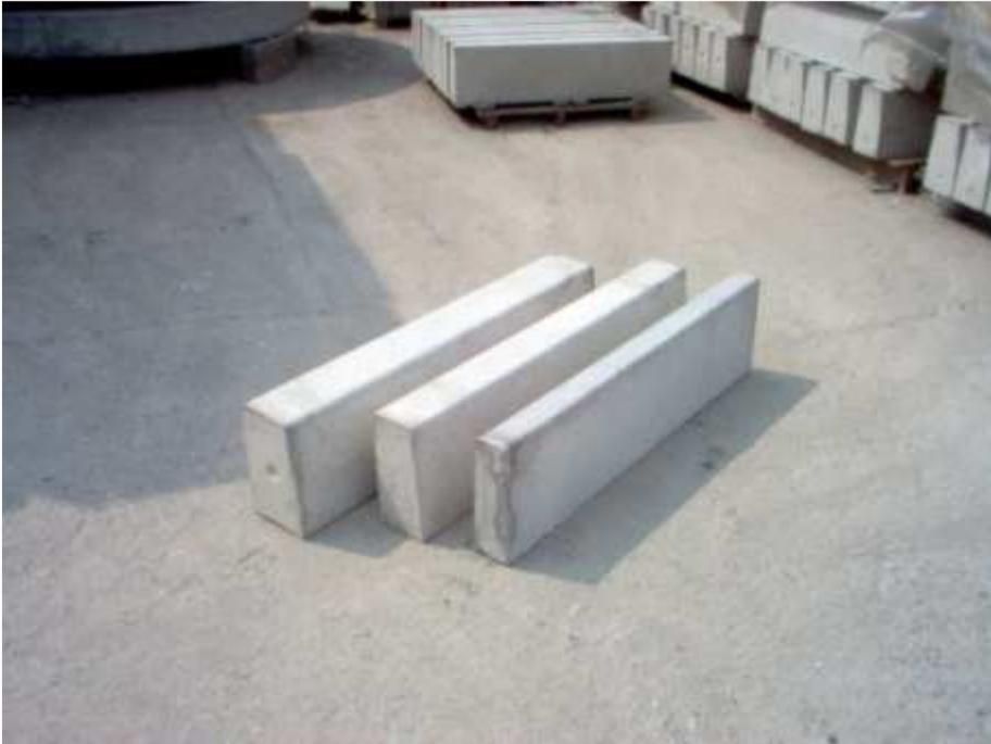
I nostri cordoli sono prodotti con appositi mescolatori, con metodo vibrogettato (liscio), con un impasto formato da cemento AR e inerti di cava lavata aventi granulometria adeguata, senza armatura nelle sezioni sotto riportate. I cordoli descritti sono da un lato arrotondati e dall'altro a spigolo vivo; vengono utilizzati per delimitare strade e marciapiedi. Sono disponibili in elementi retti da cm 100 ed in elementi curvi nei raggi normalmente più in uso.
