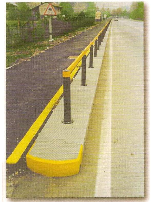
Gli elementi per piste ciclabili o per formazione isole pedonali sono prodotti con calcestruzzo **vibrogettato** o **vibrocompresso**, confezionato con appositi mescolatori, costituito da un impasto di cemento con inerti lavati di cava aventi granulometria adeguata.
