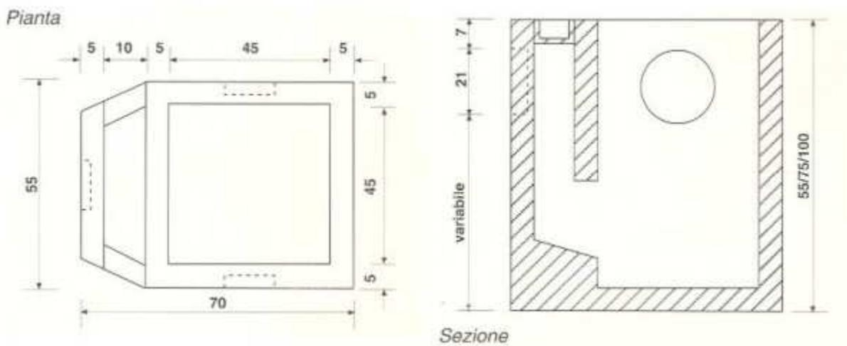
I nostri pozzetti sifonati sono prodotti con appositi mescolatori, con metodo vibropressato, con un impasto formato da cemento AR e inerti di cava lavata aventi granulometria adeguata, con armature in ferro. Il sifone incorporato permette di evitare i cattivi odori, usato soprattutto per strade, cortili e piazzali.
