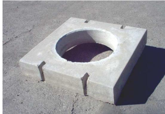
Le nostre solette sono prodotte con appositi mescolatori, con metodi vibropressato e vibrogettato, con un impasto formato da cemento AR e inerti di cava lavata aventi granulometria adeguata, con armature elettrosaldate di sezione adeguata.
