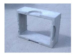
I nostri torrini da prolunga sono prodotti con appositi mescolatori, con metodo vibropressato, con un impasto formato da cemento AR e inerti di cava lavata aventi granulometria adeguata, con armature in ferro a seconda delle dimensioni del torrino.
